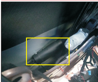
15、将安装支架用双面胶沾固在门边上,然后将电机卡在支架上即可
