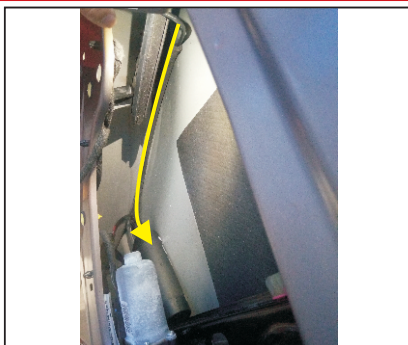
16、拉线安装必须顺畅,不要有强折弯,以免拉线不回弹
