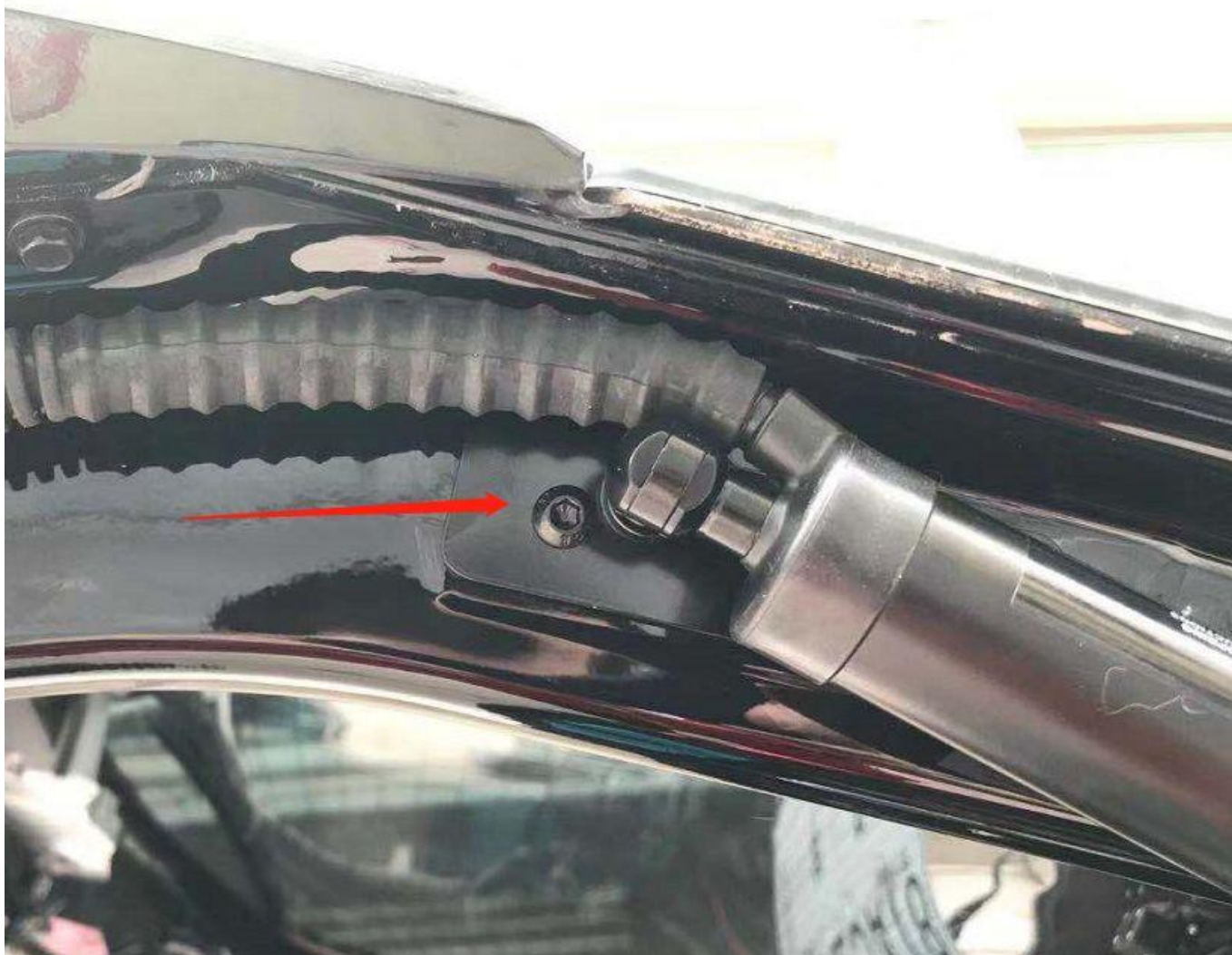
用原车球头安装撑杆
