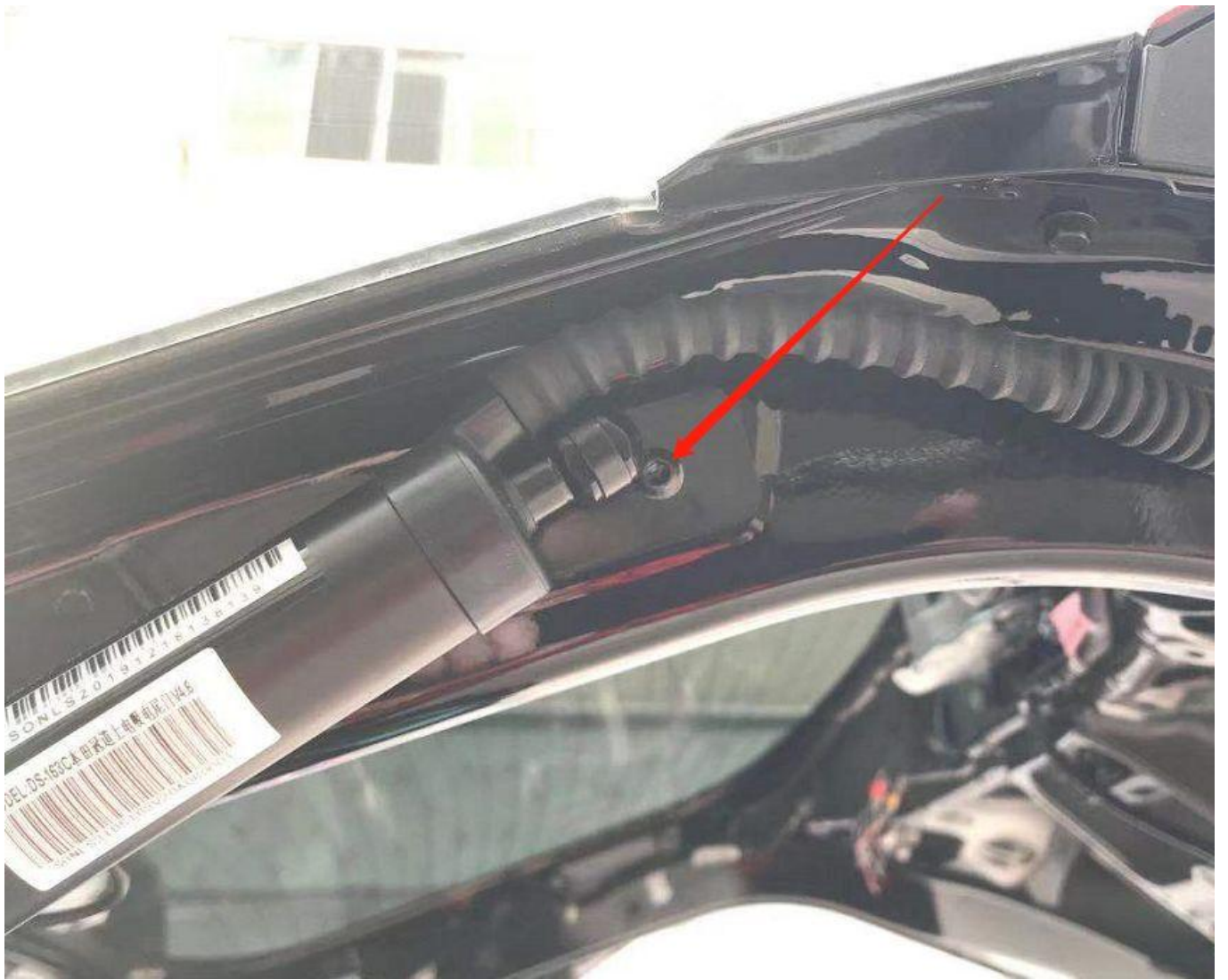
用原车球头安装撑杆
