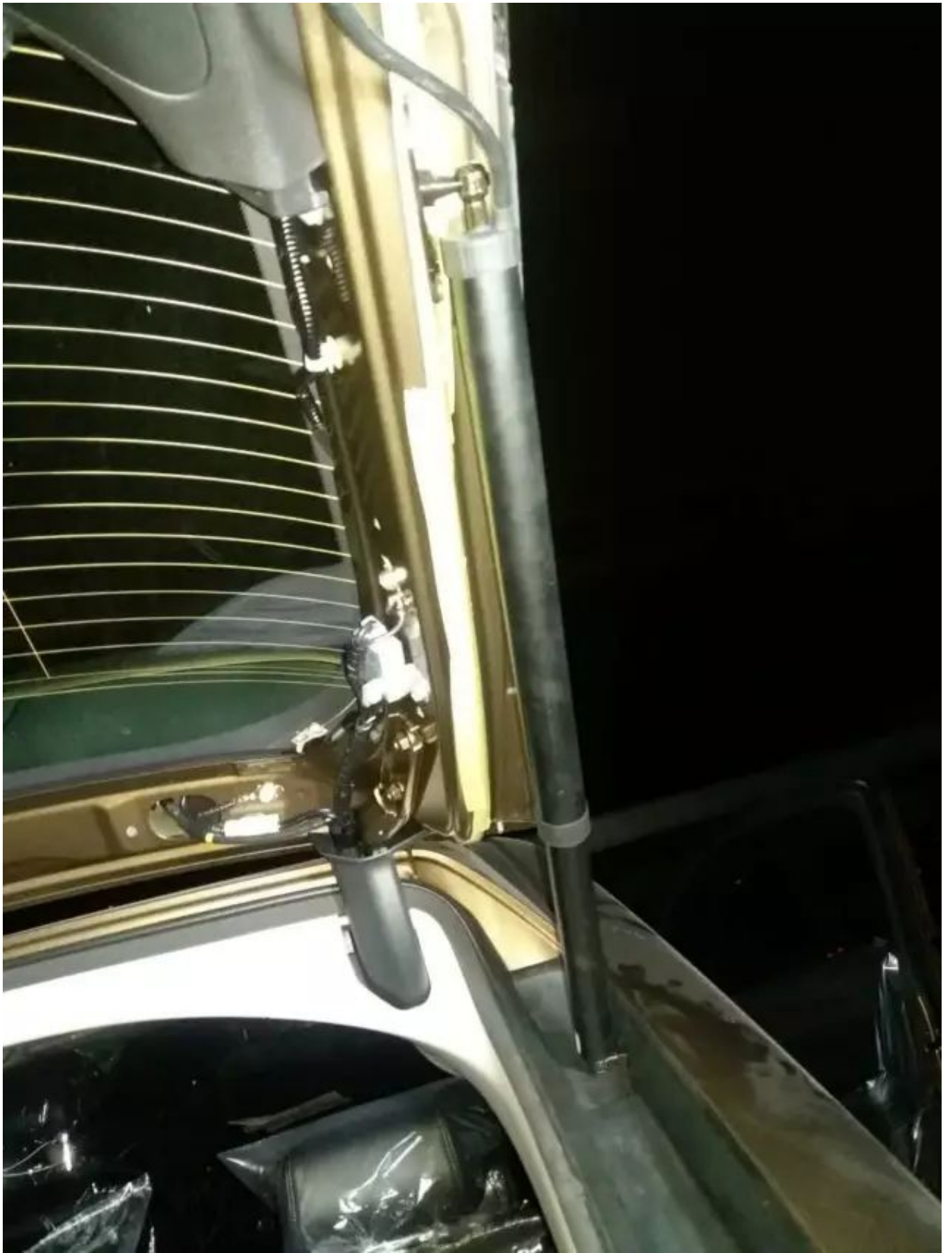
用原车支架安装撑杆
