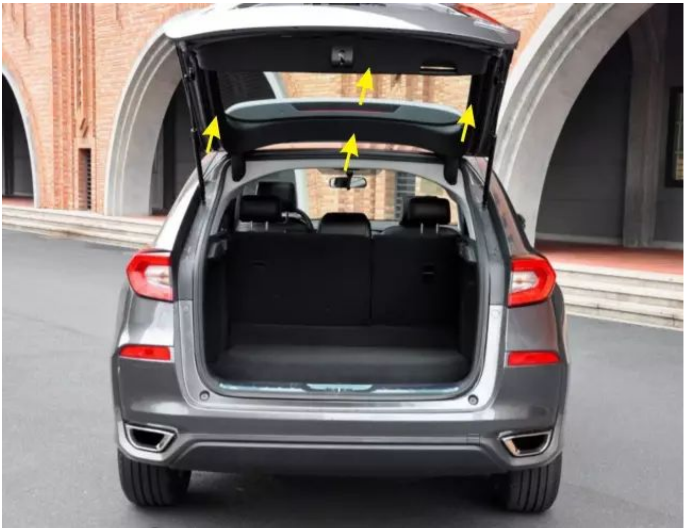
用原车支架安装撑杆
