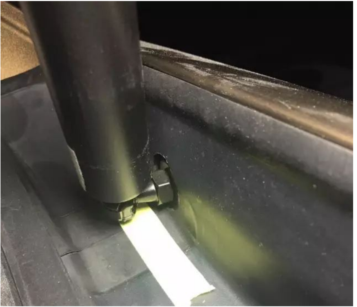
安装撑杆（左右步骤一样）
