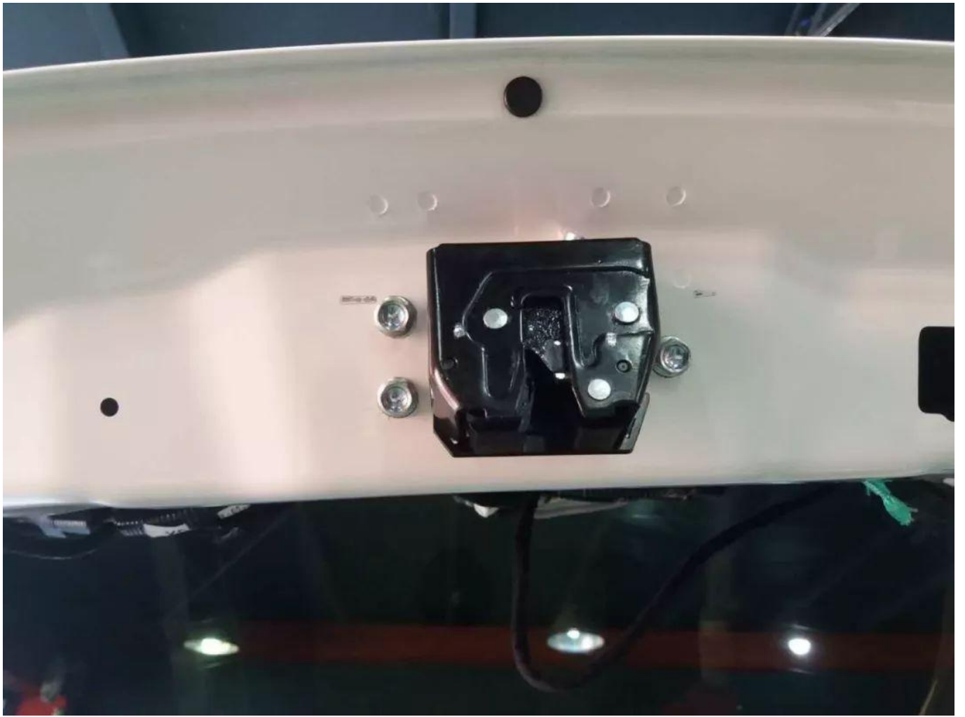
如图所示对插我司上电吸插座
